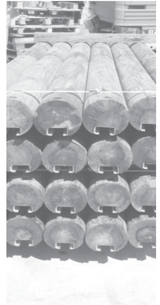
Rollizos con su perfil metálico de refuerzo
